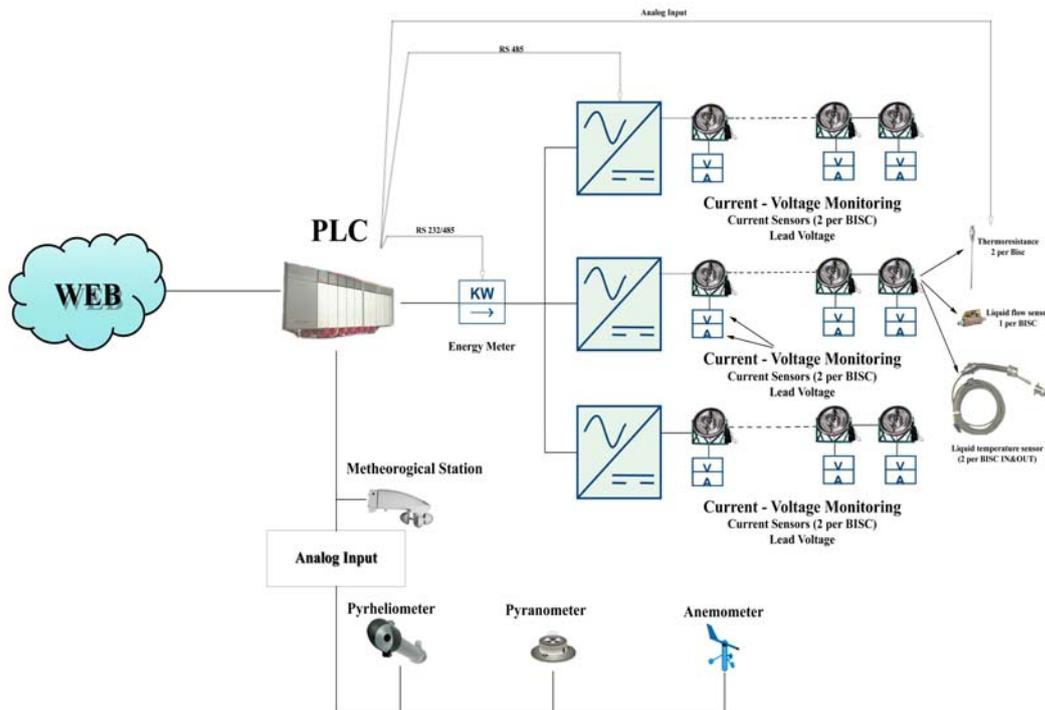
Fig. 1. Architettura del sistema e monitoraggio e controllo per Sistemi a Concentrazione Ibridi atti alla produzione combinata di energia elettrica e termica da fonte solare
