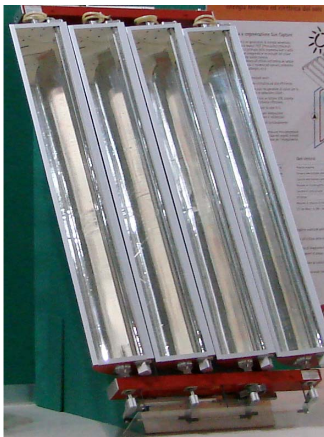
Fig. 1. Sistema a Concentrazione Ibrido per la produzione combinata di energia elettrica e termica per mezzo di un sistema a collettore lineare e inseguimento ad un asse.
